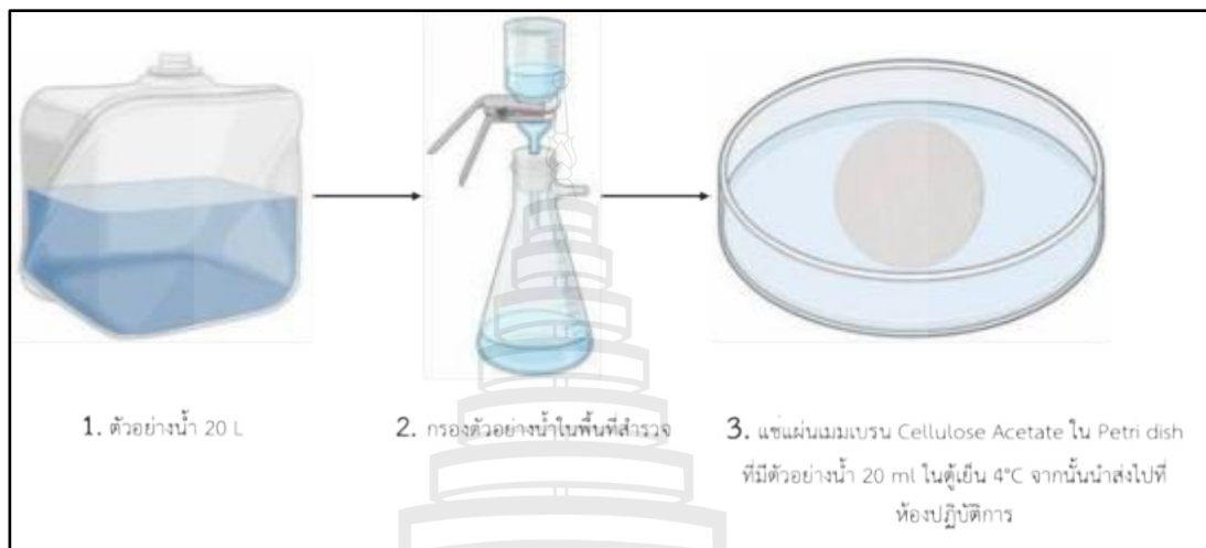
ภาพที่ 3.2 ขั้นตอนการเตรียมตัวอย่างน้ำเพื่อการกรองตัวอย่างน้ำ
