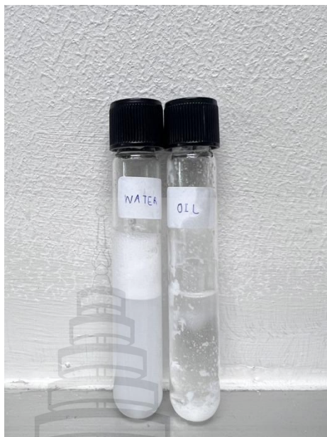
ภาพที่ 4.8 ภาพการทดสอบชนิดของอิมัลชันด้วยตัวทำละลายที่ต่างชนิดกัน Dilution Test (การเจือจาง)
