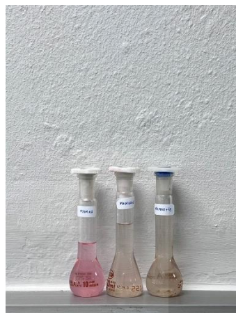
ภาพที่ 4.6 แสดงค่าพีเอชที่ต่างกันในสภาวะกรด-เบสส่งผลต่อสีที่แสดงออกของสารสกัดจากผลมะเมาะก่อนการทดสอบและหลังการทดสอบ
