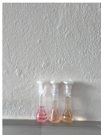
ภาพที่ 4.6 แสดงค่าพีเอชที่ต่างกันในสภาวะกรด-เบสส่งผลต่อสีที่แสดงออกของสารสกัดจากผลมะเมาะก่อนการทดสอบและหลังการทดสอบ
