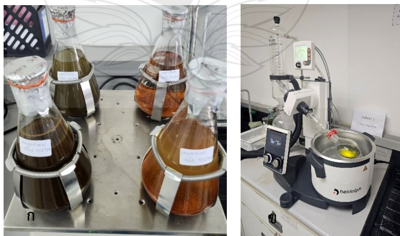
ภาพที่ 3.4 การสกัดด้วยวิธีแบบดั้งเดิม (ก), การนำตัวทำละลายออกด้วยวิธี Rotary Evaporator (ข)
