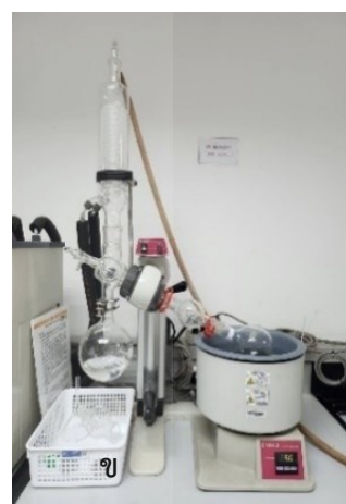
ภาพที่ 3.5 การสกัดด้วยคลื่นความถี่สูง (ก), การนำตัวทำละลายออกด้วยวิธี Rotary Evaporator (ข)
