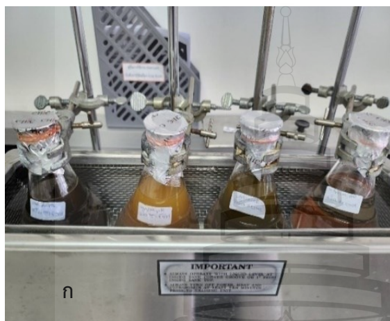
ภาพที่ 3.5 การสกัดด้วยคลื่นความถี่สูง (ก), การนำตัวทำละลายออกด้วยวิธี Rotary Evaporator (ข)
