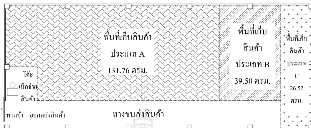
ภาพที่ 4.19 แผนผังจัดเก็บวัตถุดิบและสินค้าตามประเภทของวัตถุดิบและสินค้า
