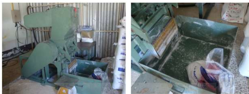
ภาพที่ 2.32 เศษฝุ่นที่ได้จากการบดพลาสติกกรีไซเคิล
