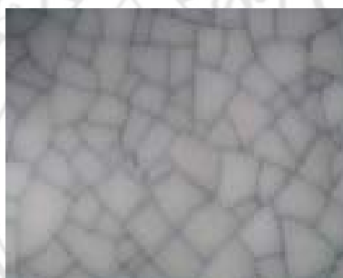
ภาพที่ 4.8 ค่าความแตกต่างของการขยายตัวเชิงความร้อนของเคลือบและเนื้อดินป้อนสูตรที่ 2 ใช้ควอทซ์เป็นส่วนผสมในเคลือบ
