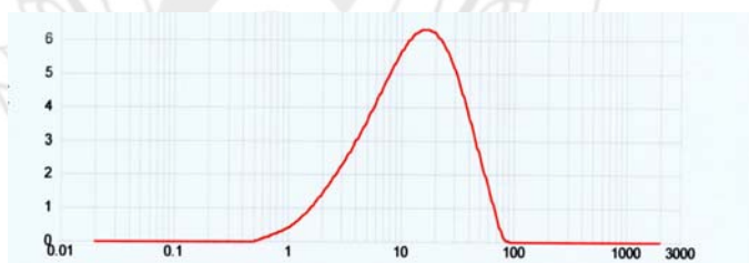
ภาพที่ 3.15 การกระจายตัวขนาดอนุภาคของเถ้ากลบที่ผ่านการเผา ที่อุณหภูมิ 600 ช. เป็นเวลา 4 ชม.
