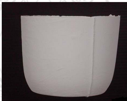
รูปที่ 4.17 ถ้วยที่ได้จากการเผาแคลไซต์ที่อุณหภูมิ 1,250 องศาเซลเซียส
