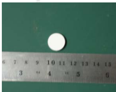
รูปที่ 4.3 ลักษณะชั้นทดสอบที่เตรียมการอัดขึ้นรูปผงเซรามิก
