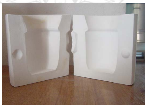
รูปที่ 3.9 พิมพ์หล่อปูนพลาสเตอร์แบบประกบ
