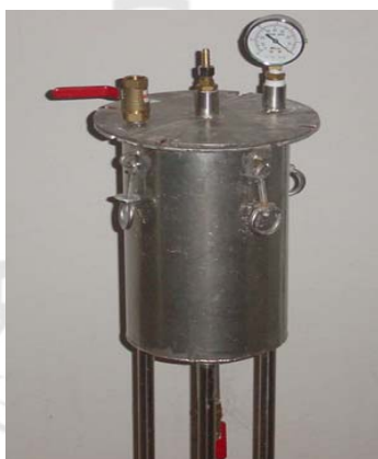
รูปที่ 3.10 ถังสุญญากาศสำหรับกำจัดฟองอากาศในน้ำสลิป
