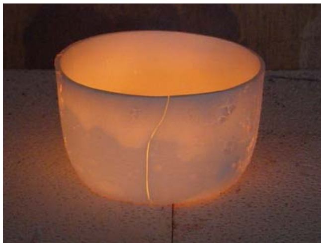
รูปที่ 4.18 ผลิตภัณฑ์ทำจากวัสดุอะลูมินา เกิดความเสียหายจากการเปลี่ยนแปลงอุณหภูมิ ฉับพลัน
