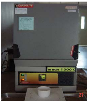
รูปที่ 3.8 เตาเผาไฟฟ้าใช้สำหรับทดสอบการเปลี่ยนแปลงอุณหภูมิฉับพลันด้วยอากาศ
