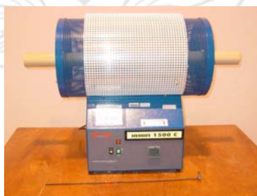
รูปที่ 3.7 เตาไฟฟ้าแบบท่อที่ใช้ทดสอบการเปลี่ยนแปลงอุณหภูมิฉับพลันด้วยน้ำ
