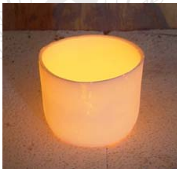
รูปที่ 4.19 ถ้วยที่ทำจากวัสดุอะลูมินาเต็มเซอร์โคเนียร้อยละ 20
