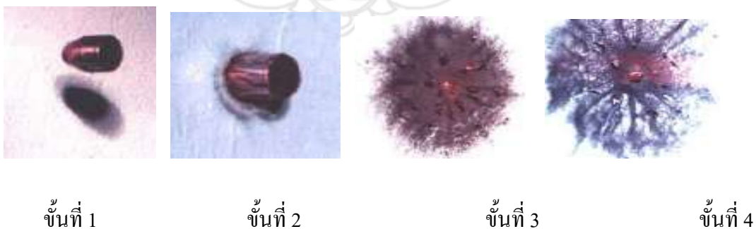
รูปที่ 2.1 แสดงถึงลักษณะการแตกหักของหัวกระสุนชนิดแตกหักได้เมื่อกระทบเป้า
