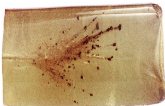
(a) หัวกระสุนผ่านเจลและแตกเป็นชิ้นส่วนขนาดเล็ก
