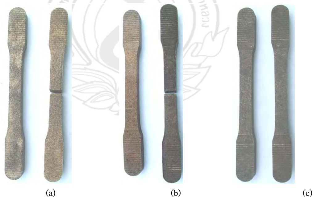
รูปที่ 4.7 ชิ้นงาน A2 ที่ซินเทอร์อุณหภูมิ 800 850 900^{\circ}\text{C} เป็นเวลา 45 นาที
