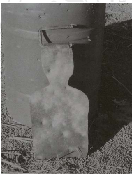
รูปที่ 2.3 ตัวอย่างผลการยิงของกระสุนชนิดแตกหักได้ Frangible bullet, (Non-toxic round) ซึ่งไม่ทำลายเป้าฝึกยิงปืน (Mullins, 2001)
