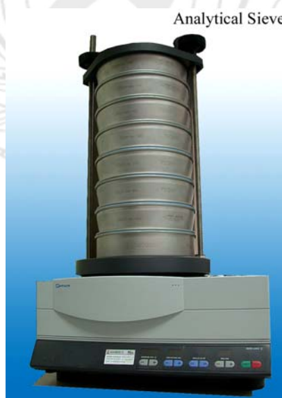
รูปที่ 3.1 เครื่องคัดขนาดโลหะผงยี่ห้อม Retsch รุ่น AS200 Control 'g'
