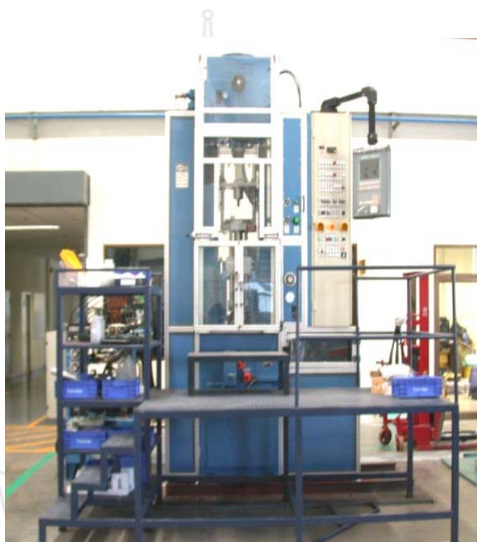
รูปที่ 3.2 เครื่องอัดชิ้นงานยี่ห้อ Drost รุ่น TPA50/4
