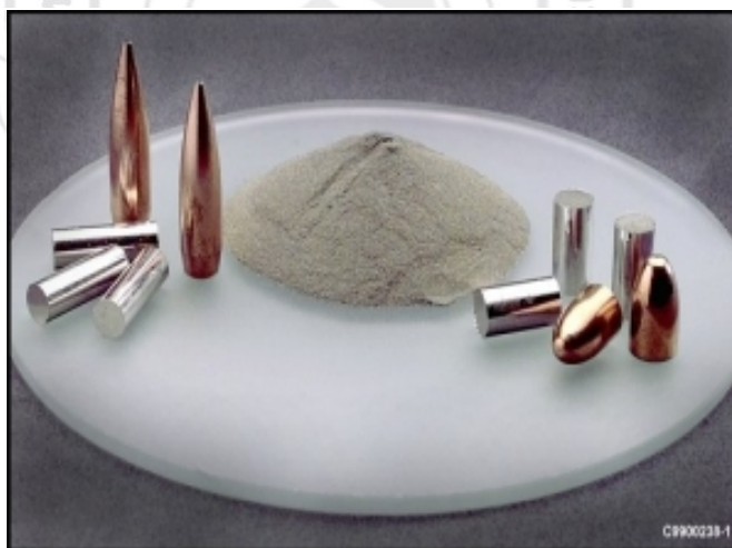
รูปที่ 2.4 ตัวอย่างกระสุนชนิดแตกหักได้บางชนิดที่ผลิตจากผงโลหะอัดขึ้นรูป (Mikko, 2000)
