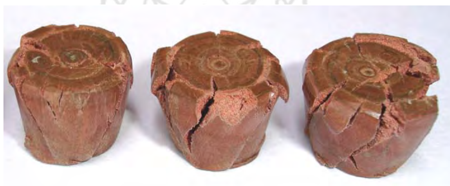
รูปที่ 4.23 ลักษณะการแตกของหัวกระสุนแตกหักได้ Frangible bullet 85 Gr (Luger)
