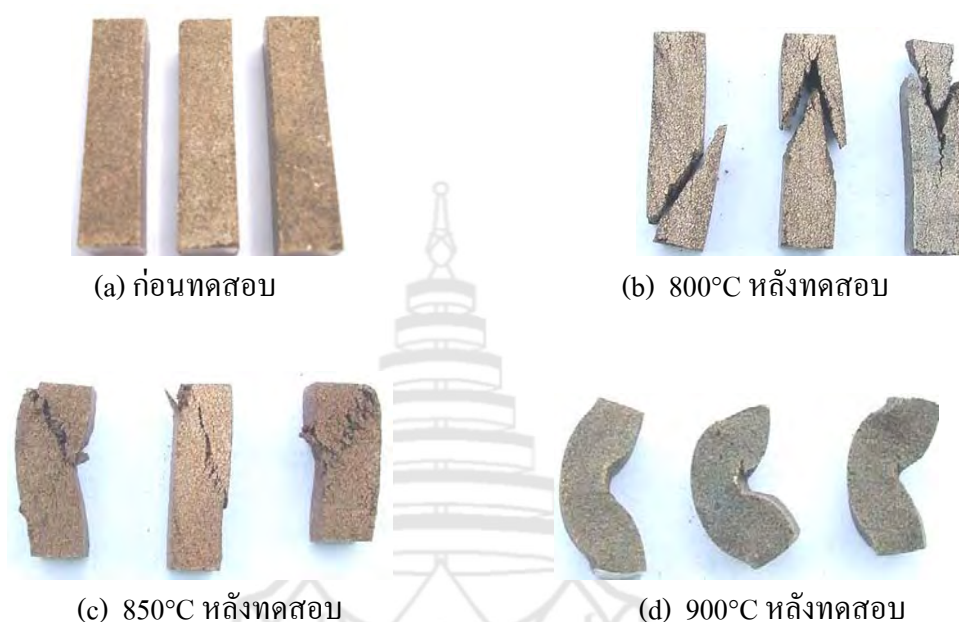
รูปที่ 4.13 ลักษณะการแตกหักของชิ้นวัสดุหลังการทดสอบความต้านทานแรงกด
