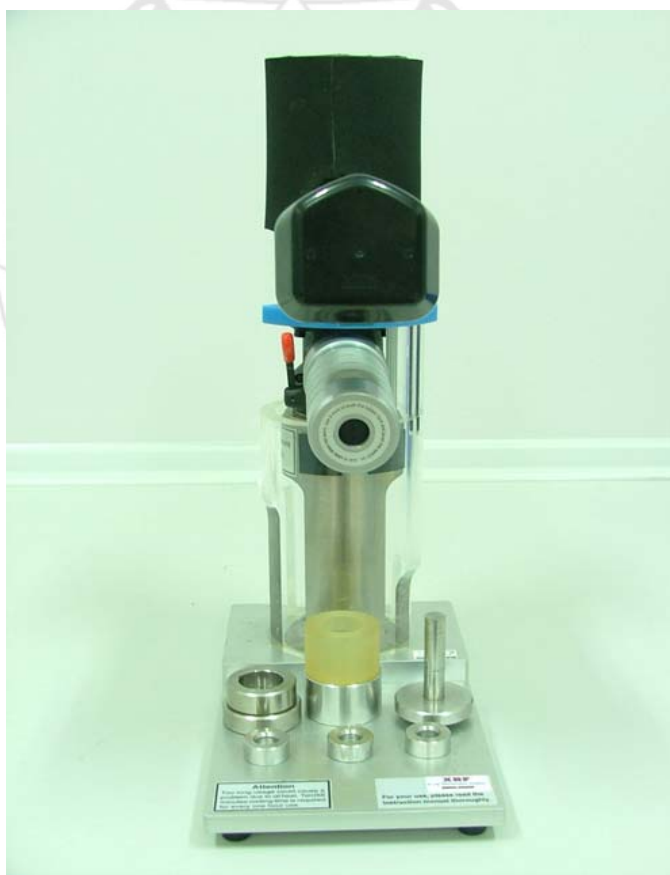
ภาพที่ 3.11 แสดงชุดอัดตัวอย่างทดสอบสำหรับใช้วิเคราะห์หาองค์ประกอบทางเคมี
