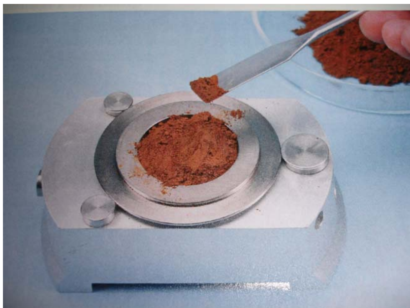
ภาพที่ 3.3 แสดงการนำเถ้าเคลือบตัวอย่างบรรจุลงในที่ใส่ตัวอย่างทดสอบ (Holder Ring)
