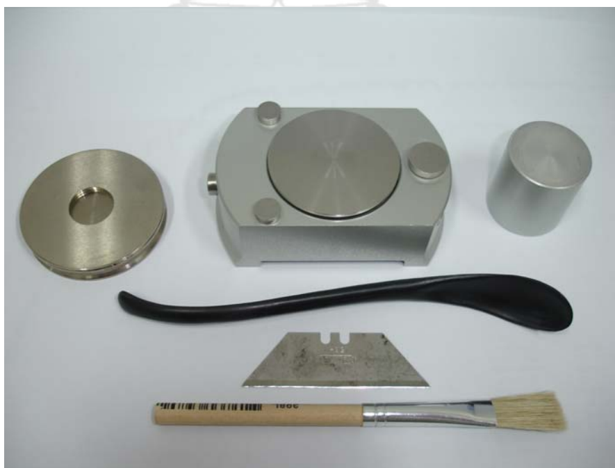
ภาพที่ 3.2 แสดงที่บรรจุตัวอย่างในการทดสอบหาโครงสร้างผลึกโดยการเลี้ยวเบนของรังสีเอ็กซ์
