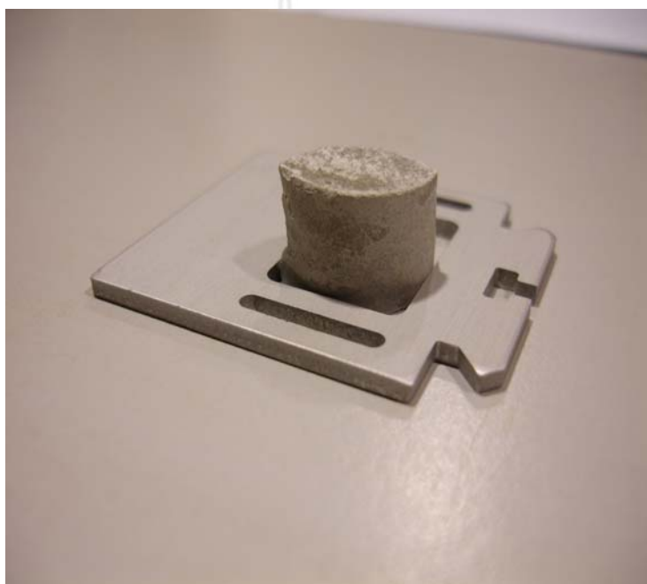
ภาพที่ 3.19 แสดงชิ้นทดสอบซีเมนต์เพสต์สำหรับศึกษาโครงสร้างผลึกด้วยเทคนิคการเลี้ยวเบนของรังสีเอกซ์
