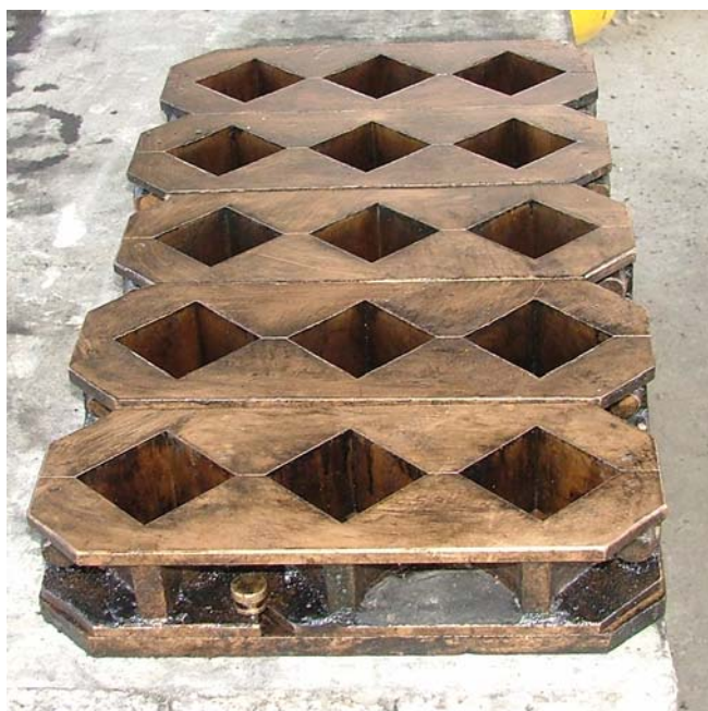
ภาพที่ 3.17 แสดงแบบหล่อขึ้นมอร์ต้าร์ทดสอบ
