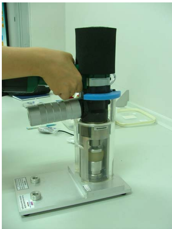
ภาพที่ 3.14 นำชุดที่ใช้เตรียมตัวอย่างบรรจุเข้าในเครื่องเตรียมและทำการเตรียมโดยการกด
