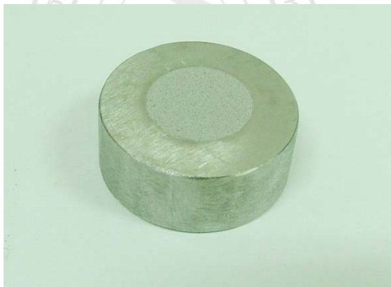
ภาพที่ 3.15 ตัวอย่างทดสอบสำหรับใช้วิเคราะห์หาองค์ประกอบทางเคมีที่เตรียมเรียบร้อยแล้ว
