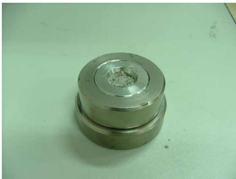
ภาพที่ 3.12 การนำแก้วเคลือบตัวอย่างบรรจุลงในที่ใส่ตัวอย่างทดสอบ
