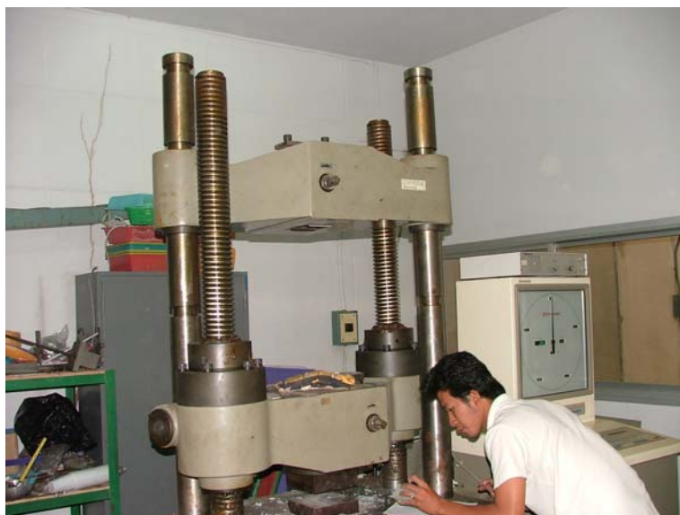
ภาพที่ 3.18 เครื่องทดสอบแรงกด SHIMADZU รุ่น UH-100A
