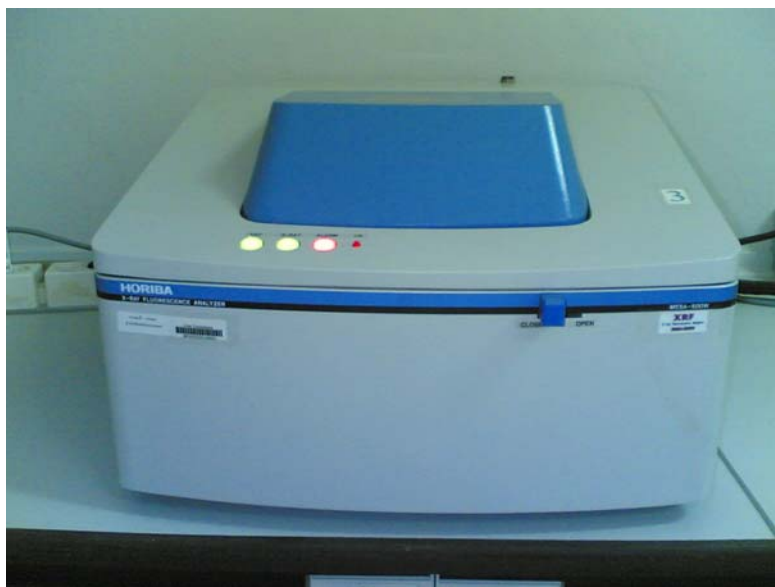
ภาพที่ 3.16 เครื่องวิเคราะห์หึ่งค์ประกอบทางเคมี Horiba รุ่น Mesa-500w
