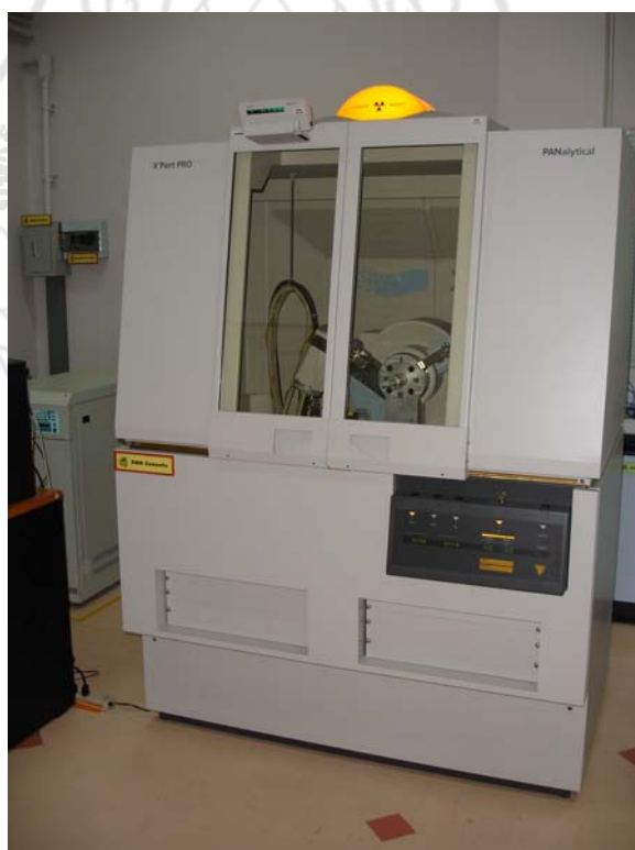
ภาพที่ 3.8 เครื่องวิเคราะห์โครงสร้างผลึก PANalytical รุ่น X'Pert PRO MPD
