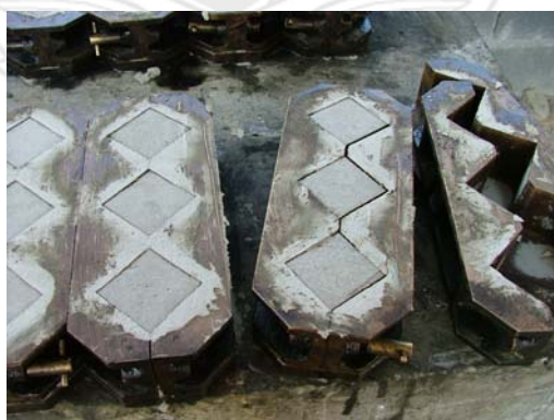
ภาพที่ ก3 แสดงมอร์ตาร์ที่เทหล่อเสร็จเรียบร้อยแล้วพร้อมนำไปบ่ม
