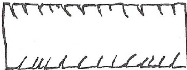
รูปที่ 2.12 ภาพตัดขวางแสดงการฉีกของผิวดินบริเวณด้านข้าง (Onoda and Hench, 1978)
