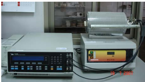
รูปที่ 3.1 เครื่องวัดค่าความต้านทานเชิงซ้อน (Impedance spectroscopy) ต่อกับเตาไฟฟ้าแบบท่อ 1300 องศาเซลเซียส
