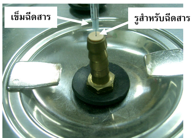
รูปที่ 3.6 ระบบหัวฉีด (Injector)
