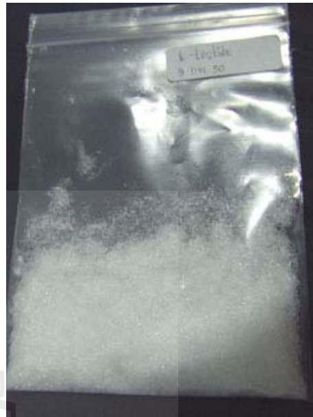
รูปที่ 4.2 ลักษณะผลึกของแอล-แลคไทด์ ที่ผ่านการทำให้บริสุทธิ์ 3-4 ครั้ง
