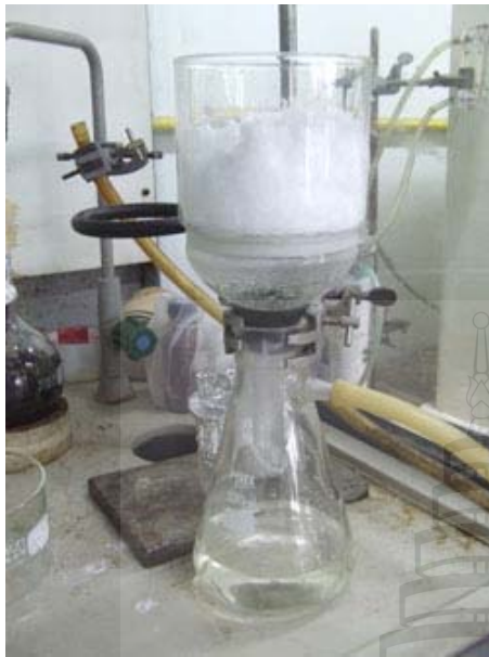
รูปที่ 4.2 ลักษณะผลึกของแอล-แลคไทด์ ที่ผ่านการทำให้บริสุทธิ์ 3-4 ครั้ง
