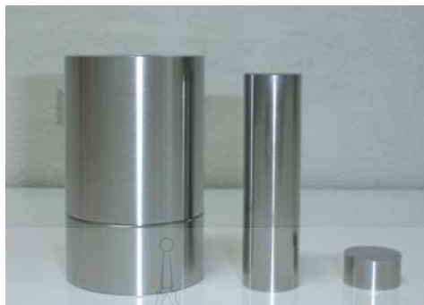
รูปที่ 3.2 โมลเหล็กกล้าสำหรับการขึ้นรูปแบบพิมพ์อัด
