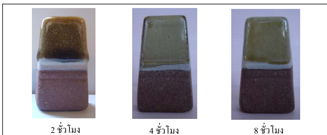
ภาพที่ 4.46 ชิ้นทดสอบเคลือบสูตร 4 บดเวลา 2 4 และ 8 ชั่วโมง โดยกรองเคลือบ ผ่านตะแกรง 100 เมช เผาที่อุณหภูมิ 1230°C
