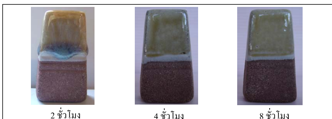
ภาพที่ 4.45 ชิ้นทดสอบเคลือบสูตร 3 บดเวลา 2 4 และ 8 ชั่วโมง โดยกรองเคลือบ ผ่านตะแกรง 100 เมช เผาที่อุณหภูมิ 1230^{\circ}\text{C}
