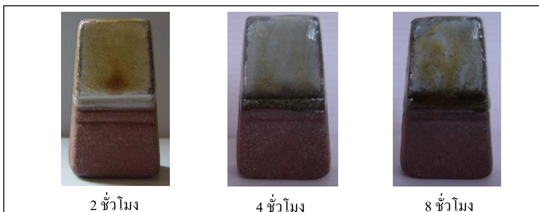
ภาพที่ 4.37 ชั้นทดสอบเคลือบสูตร 1 บดเวลา 2 4 และ 8 ชั่วโมง เเผาที่อุณหภูมิ 1230°C
