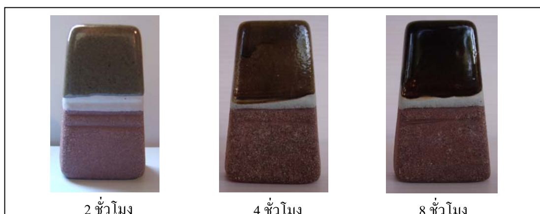
ภาพที่ 4.47 ชิ้นทดสอบเคลือบสูตร 5 บดเวลา 2 4 และ 8 ชั่วโมง โดยกรองเคลือบ ผ่านตะแกรง 100 เมช เผาที่อุณหภูมิ 1230°C
