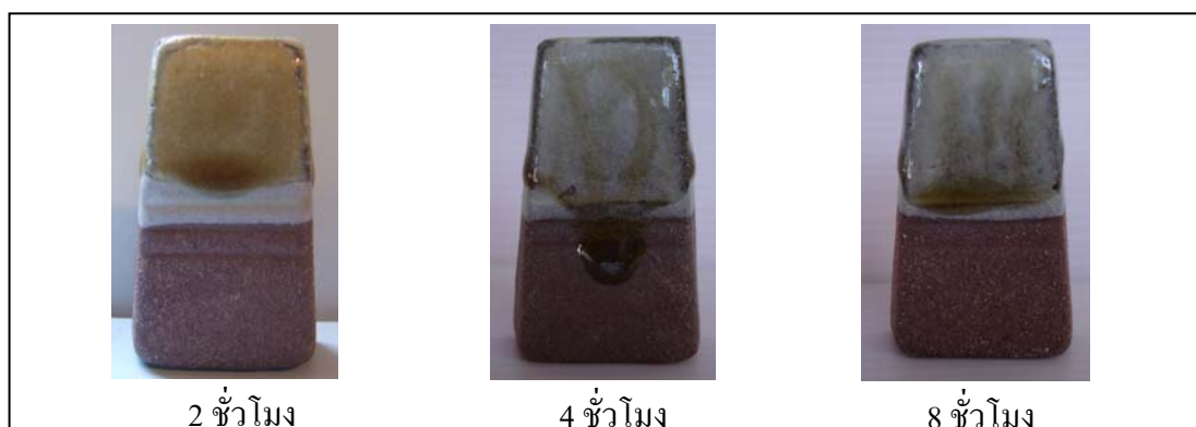
ภาพที่ 4.43 ชิ้นทดสอบเคลือบสูตร 1 บดเวลา 2 4 และ 8 ชั่วโมง โดยกรองเคลือบ ผ่านตะแกรง 100 เมช เผาที่อุณหภูมิ 1230^{\circ}\text{C}
