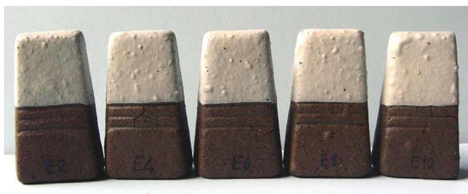
ภาพที่ ข1 แสดงตำหนิที่เกิดขึ้นบนเนื้อดิน YC หลังการเผาเอนโกบที่อุณภูมิ 1200 1230 และ 1250 องศาเซลเซียส
