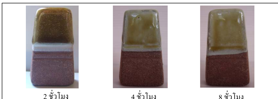
ภาพที่ 4.44 ชิ้นทดสอบเคลือบสูตร 2 บดเวลา 2 4 และ 8 ชั่วโมง โดยกรองเคลือบ ผ่านตะแกรง 100 เมช เผาที่อุณหภูมิ 1230^{\circ}\text{C}
