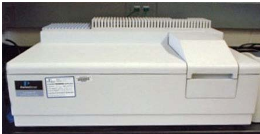
ภาพที่ 1ข เครื่อง UV-VIS spectrophotometer ยี่ห้อ Perkin Elmer รุ่น Lambda 35
