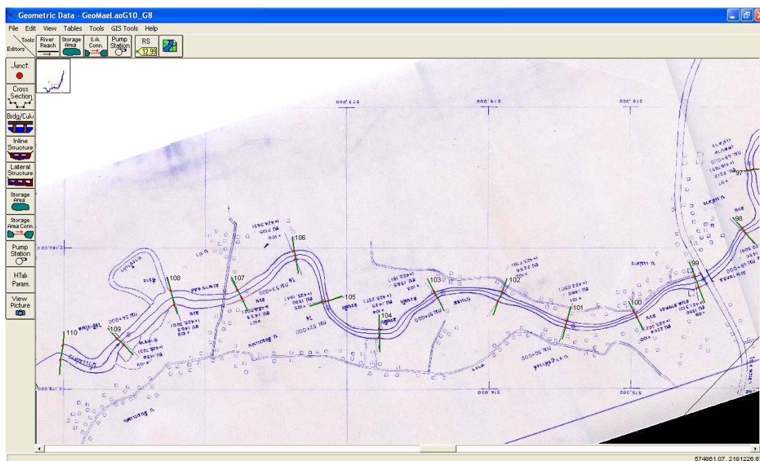
ภาพที่ ก3 ตัวอย่างการนำเข้าข้อมูลลักษณะลำน้ำจากแผนที่การสำรวจแม่น้ำแม่ลาว
