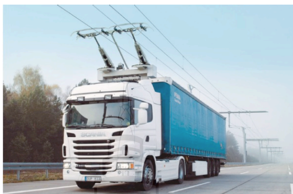
ภาพที่ 2.1 ระบบการจ่ายไฟฟ้าผ่านตัวนำทางด้านบนของตัวรถ (Overhead Conductive) 101
