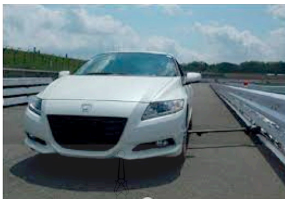
ภาพที่ 2.3 ระบบการจ่ายไฟฟ้าผ่านตัวนำทางด้านข้างของตัวรถ (Vehicle Restraint Conductive) 105
