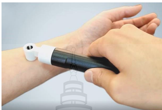
ภาพที่ 2.14 ลักษณะการวางหัว probe บริเวณผิวหนังที่ต้องการวัด
